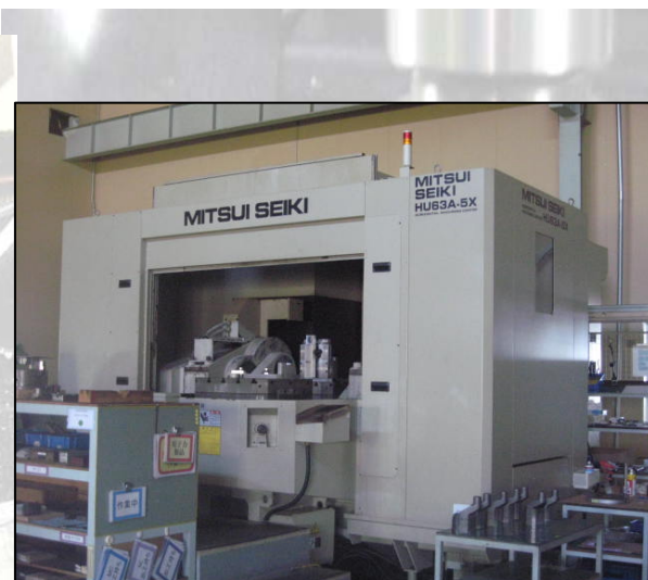
横型 5 軸マシニングセンタ X900 Y900 Z900 (HU63A-5X 三井精機工業)
