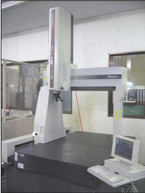
三次元測定器 (BH-V701 ミツトヨ)X700×Y1000×Z600)
