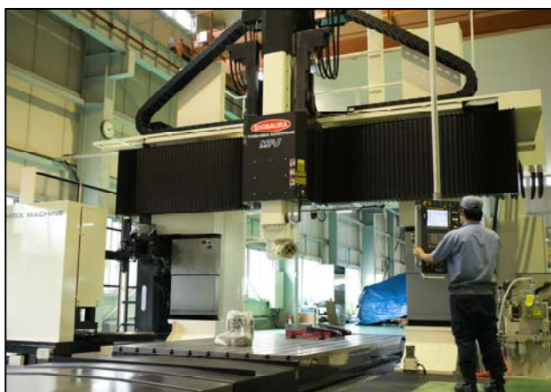
門型マシニングセンタ X2500 Y4000 Z1800 (MPJ-2640 東芝機械)
