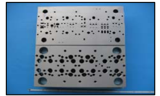
順送金型用ダイセット 材質 S50C
