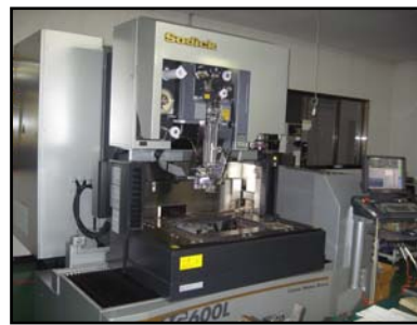
W-EDM (AG600L SODICK) ストローク X600×Y400×Z300
