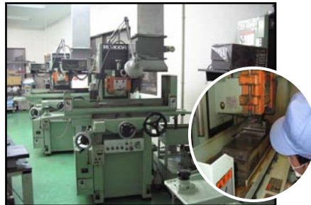
成型平面研削盤 (GS-BMH 黒田精工) ストローク X400×Y150×Z250
