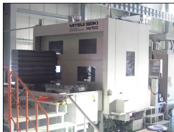
横型マシニングセンタ X1600 Y1200 Z1200 (HU100 三井精機工業)
