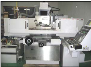
成型平面研削盤 (SP II 64EB 岡本工作機械) ストローク X600×Y400×Z250
