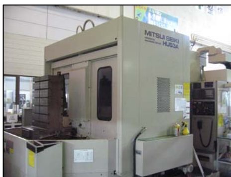
横型マシニングセンタ X900 Y800 Z800 (HU63A 三井精機工業)
