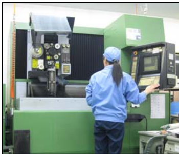
W-EDM (AQ600 SODICK) ストローク X600×Y400×Z300
