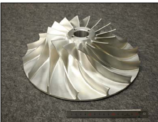
アルミ合金 φ300 同時5軸加工
