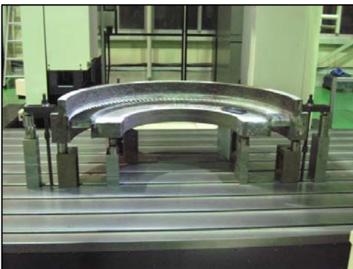
耐熱鋼 φ2500 半割品 多面加工
