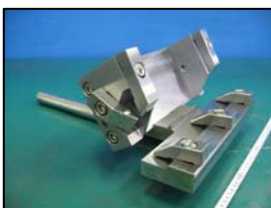
溶接治具 材質 S50C
