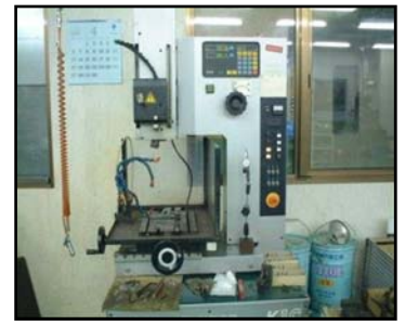
細穴加工機 (K1C SODICK) ストローク X200×Y300×Z300
