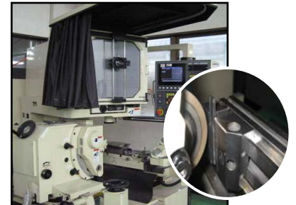
NC 微研削盤 (PGX2500N WAIDA) ストローク X200×Y150×Z100
