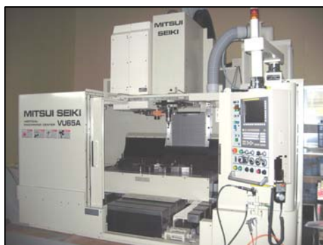
縦型マシニングセンタ X1280 Y650 Z610 (VU65A 三井精機工業)
